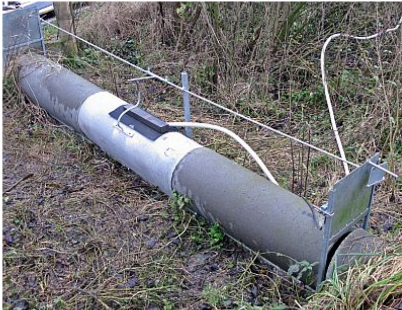
Betonrohr-Wipp-Falle, ausgestattet mit einer Infrarotkamera. Foto ITAW
