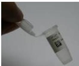
Abb.: 2: Microarray-Tube: Microarray befinden sich am Gefäßboden (3x3mm)
