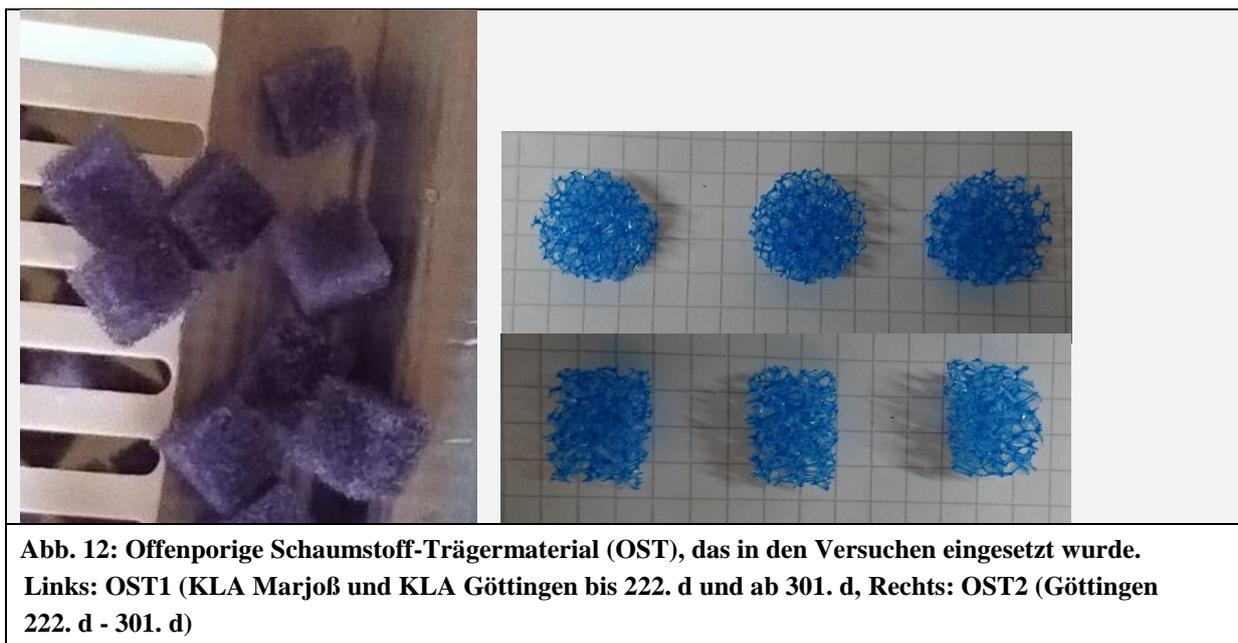
**Abb. 12: Offenporige Schaumstoff-Trägermaterial (OST), das in den Versuchen eingesetzt wurde. Links: OST1 (KLA Marjöß und KLA Göttingen bis 222. d und ab 301. d, Rechts: OST2 (Göttingen 222. d - 301. d)**
