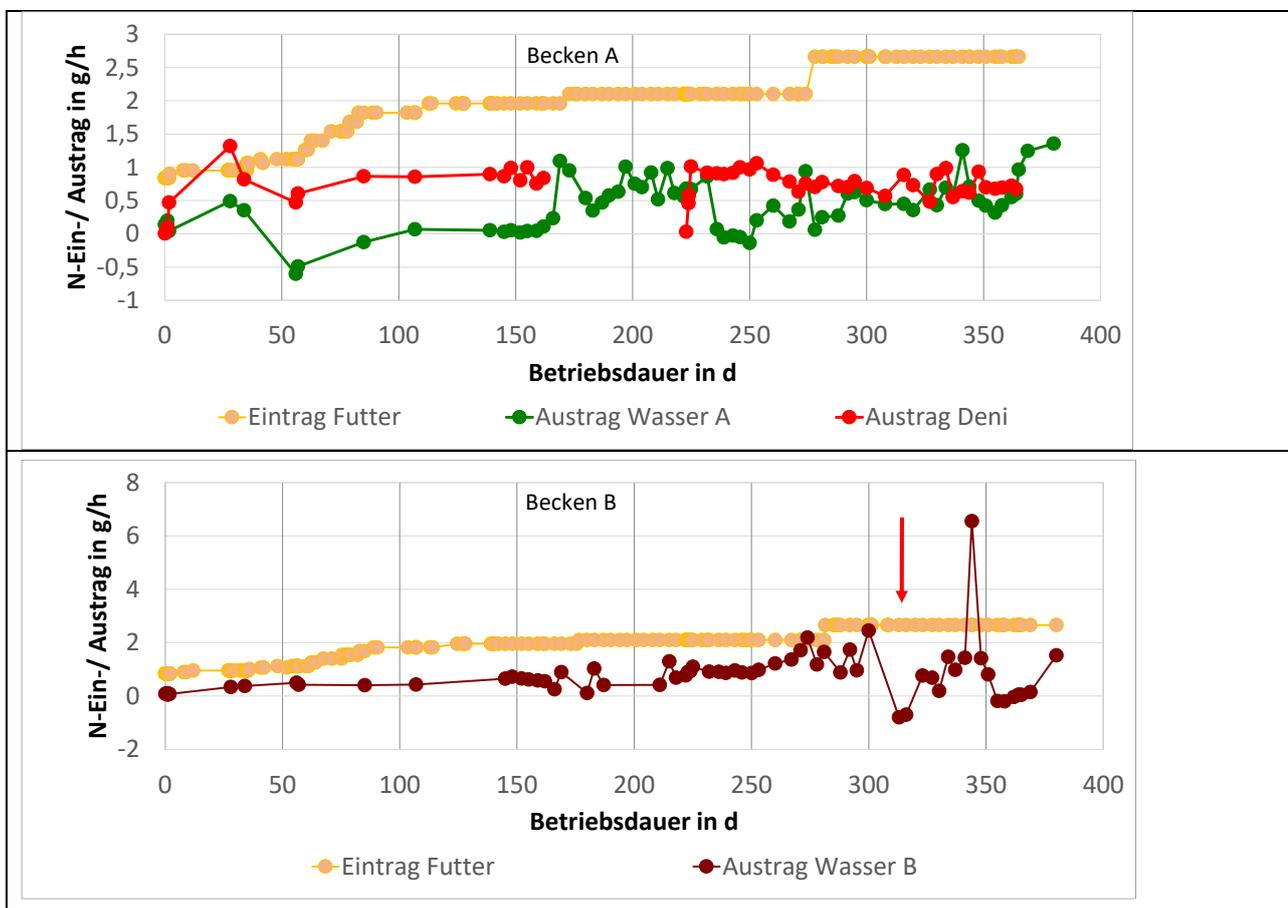
**Abb. 52: Stickstoff Ein- und Austräge (Frachten) durch Futter, MDR, Frisch- und Abwasser. „Austrag Wasser“ = (Austrag durch Ablauf - Eintrag durch Frischwasser), „A“ = Becken A, „B“ = Becken B. „Austrag Deni“ = Austrag durch Denitrifikation. Roter Pfeil: s. Text. Berechnung s. Gl. (17), (18), (19), S. 26.**
