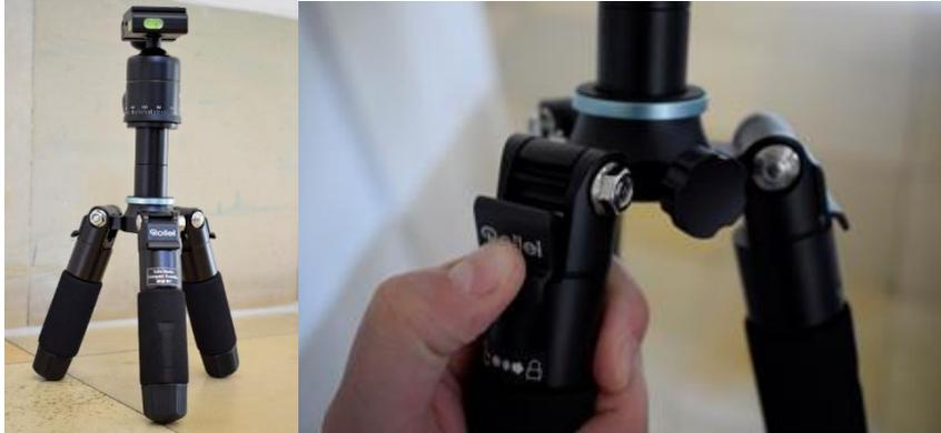
Das Kamerastativ wird ausgeklappt und kann in der Höhe an den Schraubverbindungen angepasst werden. Mit den oberen Stellschrauben können Winkelung und mit Hilfe des schraubfähigen Griffes die Beweglichkeit der Kamera eingestellt werden. Die Kamera wird auf die Fixierungsplatte aufgeschraubt, welche durch den Hebel von dem Stativ gelöst werden kann.
