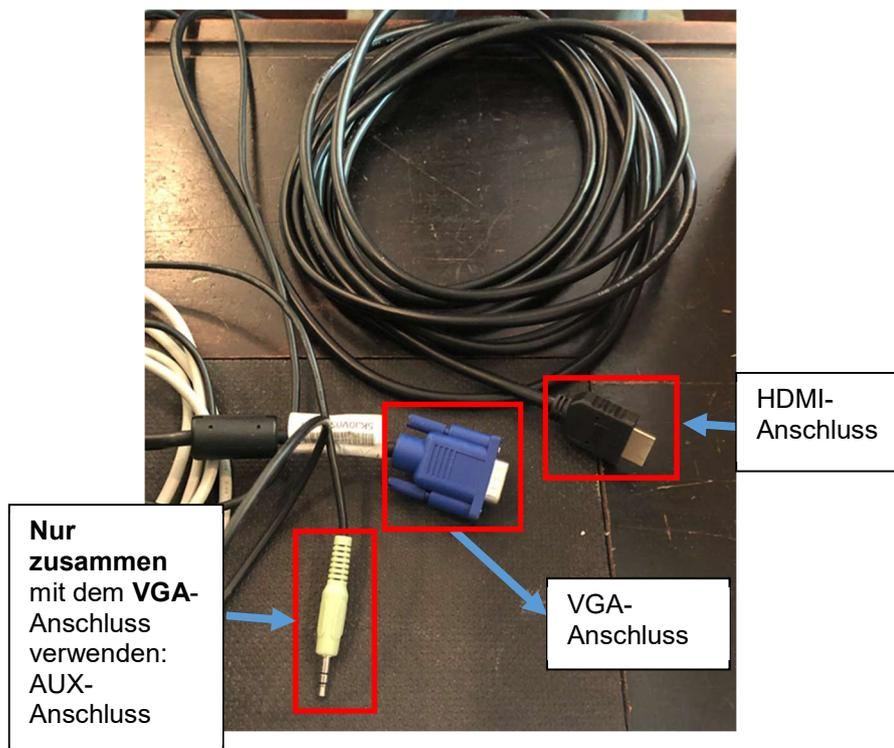
2. Anschließend müssen Sie auf dem **Touchscreen „VGA“** auswählen, sollten Sie Ihren Laptop über das VGA-Kabel angeschlossen haben. Vergessen Sie nicht, das AUX-Kabel anzuschließen.
