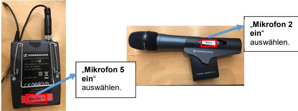
Um das Mikrofon des Modells 5 einzuschalten, klappen Sie bitte die vordere Klappe hoch und drücken den **on/off-Knopf**.
