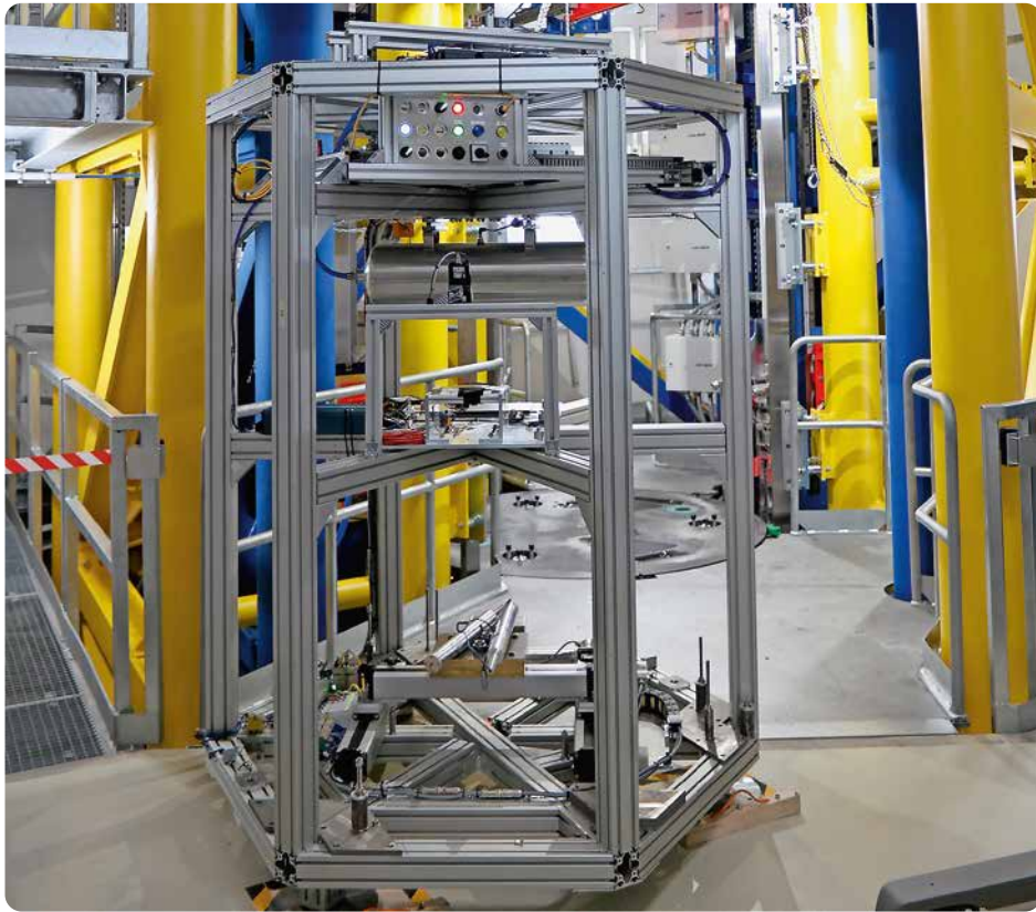
Der Einstein-Elevator: Das Aluminiumgestell ist der Versuchsträger. Auf ihm platzieren die Forschenden ihre Experimente, bevor er in die Gondel gefahren wird. Sie wird innerhalb der Führungsschienen dann entweder nach oben katapultiert oder 40 Meter nach unten fallen gelassen. Foto: Jan Fischer
